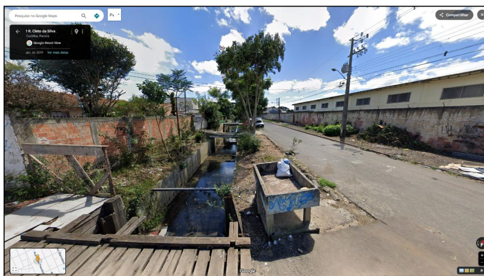
Figura 7 - Trecho retificado, com perfil retangular em elemento pré-fabricado em U [ https://maps.app.goo.gl/5PgZkHazEU13mdte6 ].
